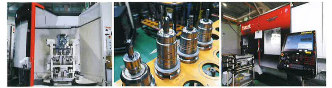
エンジンケース加工のための特注仕様クランプアングルヘッドツールラックを搭載したINTEGREX e-1250V/8
