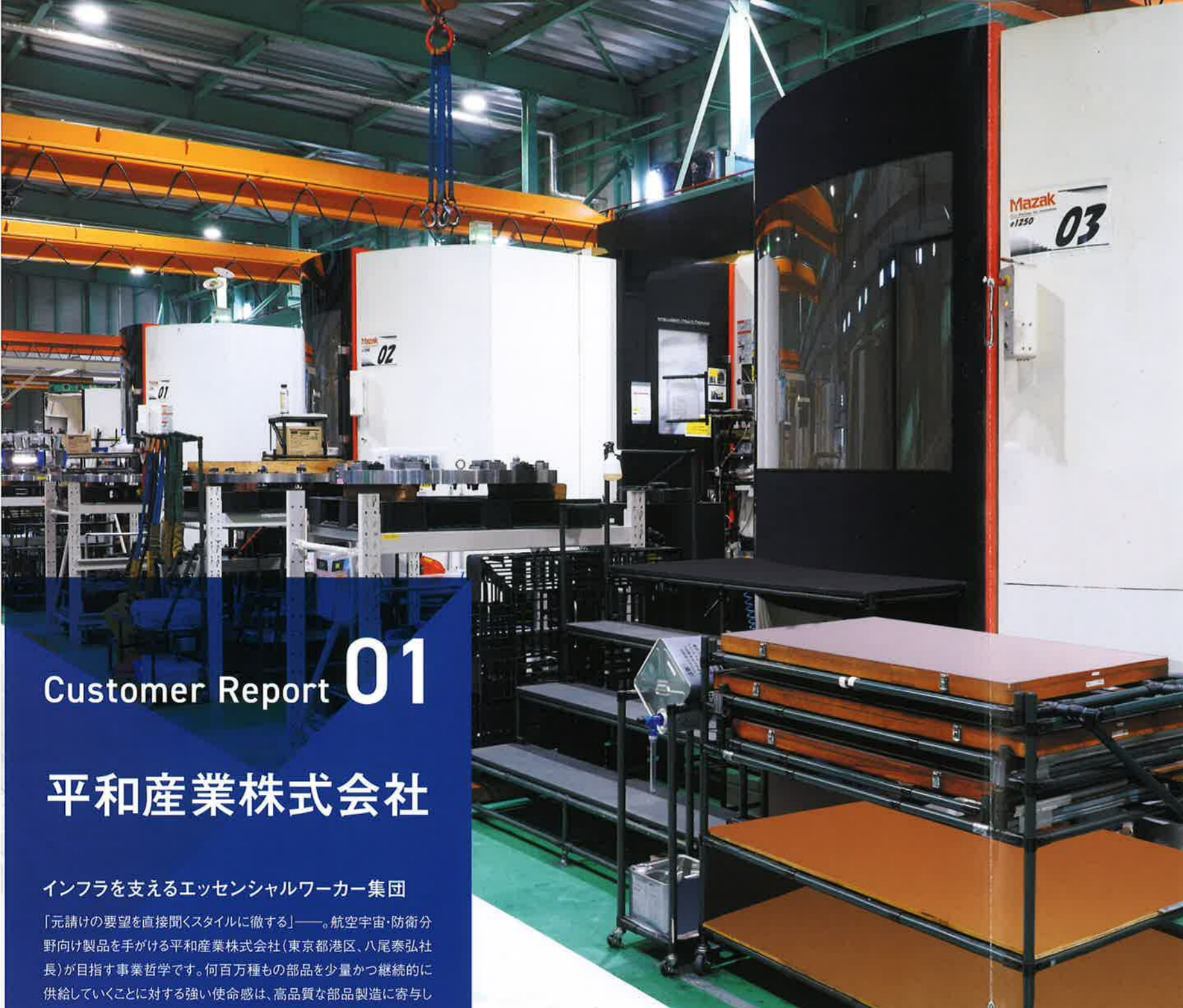
24時間体制で稼働を続ける門形複合加工機 INTEGREX e-1250V/8
